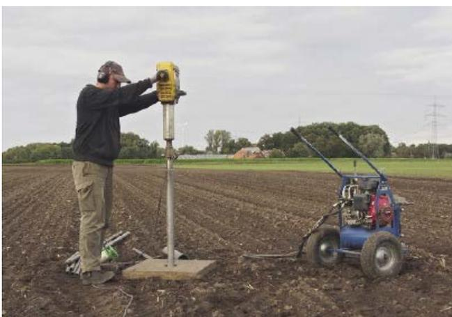
Abb. 1: Tiefsondierung mit Hilfe einer Rammkernsonde
